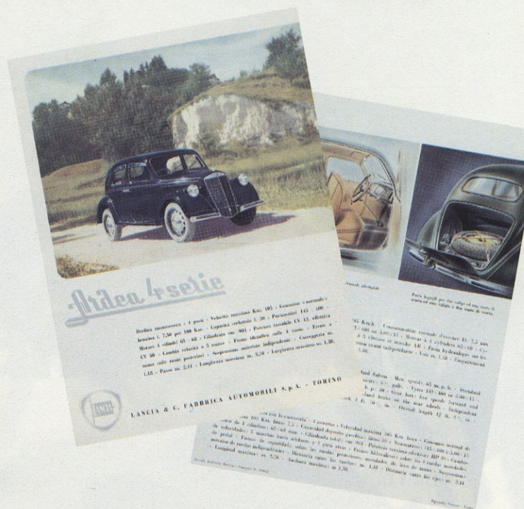
Nella pagina di fronte e qui a fianco, l'«Ardea» quarta serie. Poche le modifiche: profili al paraurti, nuovi coprimozzi e testa in alluminio.
