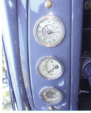
Gli altri strumenti sono collocati davanti al pilota e prevedono: indicatore livello carburante (che, in ossequio ad un'usanza tipica dell'epoca mostra il livello in litri), manometro olio e orologio con carica a 8 giorni. Moderna e ben leggibile, la grafica dai caratteri verdi su fondo bianco.
